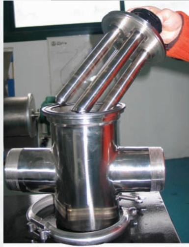
Fabricado en acero inoxidable calidad AISI-316 y conexiones con rosca "gas". Bajo pedido pueden ir equipados con bridas normalizadas.
